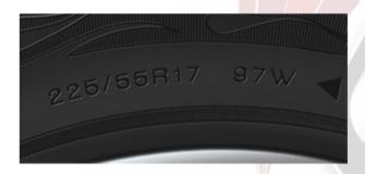
**225:** Corresponde à largura do pneu em mm. No nosso exemplo, o pneu tem 225 mm de largura
