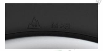
Esta marcação indica que, conforme o Regulamento Europeu, se trata de um pneu para a "neve". No entanto, as performances em condições invernosas não fazem parte do objeto dos testes.
